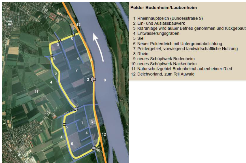
Abbildung 40: Übersicht Baumaßnahmen Polder Bodenheim/Laubenheim 49
