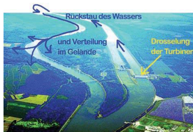
Abbildung 27: Sonderbetrieb der Rheinkraftwerke 40
