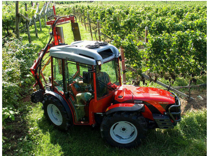
Abb. 24: Carraro Schmalspurschlepper mit Knicklenkung
