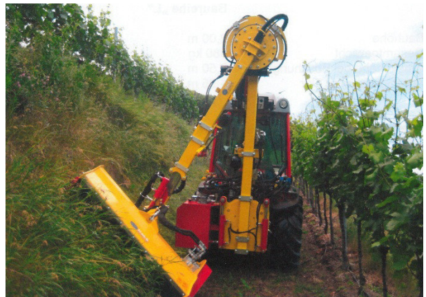
Abb. 29: Böschungsmulcher der Fa. KMS Rinklin
