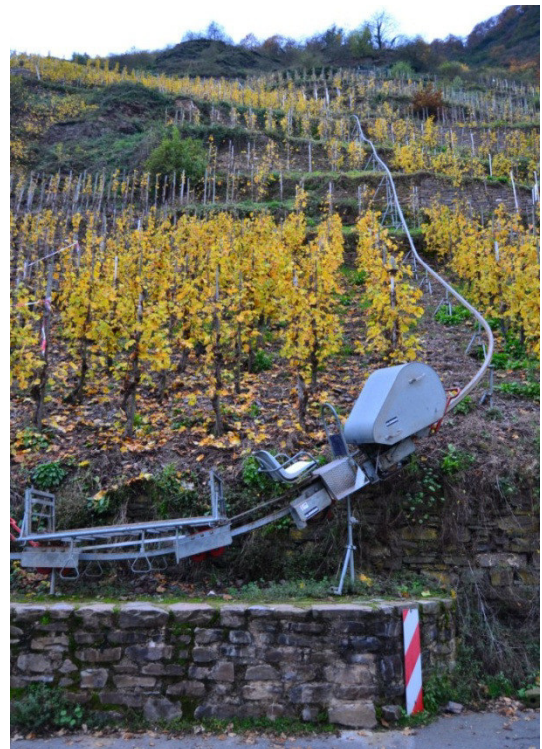
Abb. 1: Monorackbahn mit Transportwagen und abgedecktem Motor in „Parkposition“
