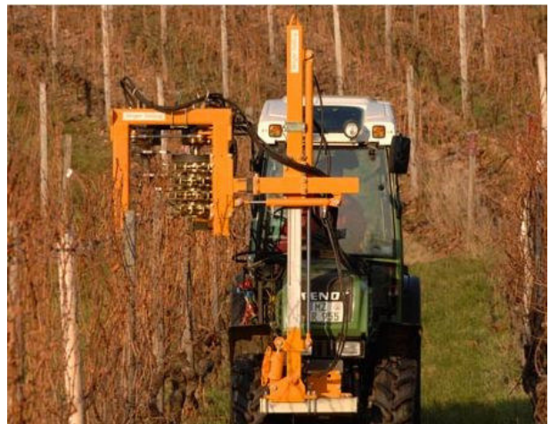
Abb. 26: Vorschneider der Fa. Binger Seilzug
