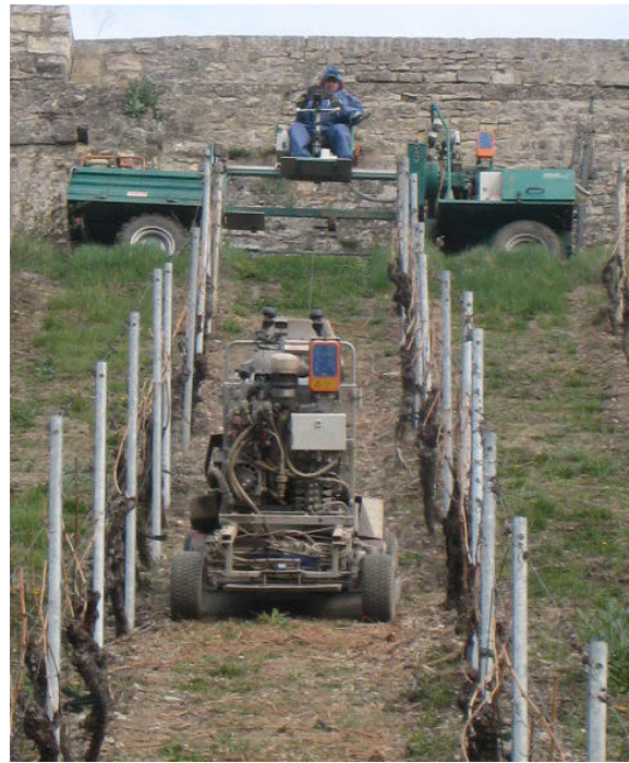
Abb. 4: Anhängerversion (VITRAK) mit eigenem Fahrantrieb und ferngesteuertem Geräteträger
