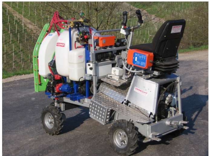
Abb. 6: Der neue Satellit der Fa. Obrecht mit Sprühgerät
