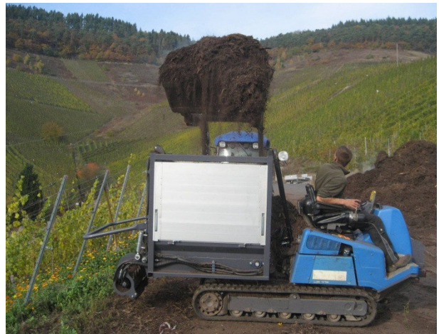
Abb. 27: Kompoststreuer auf einem RMS der Fa. Geier
