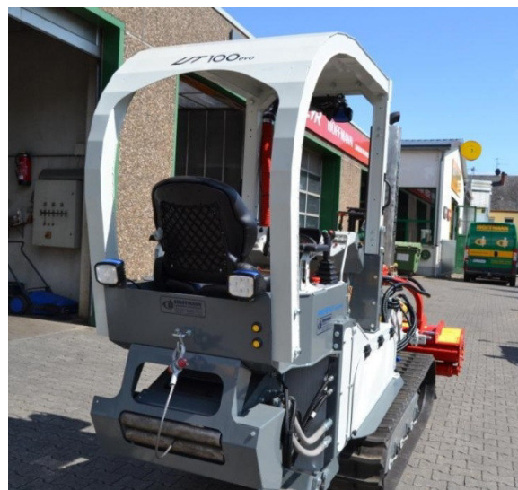
Abb. 9: RMS-Raupe der Fa. Andreoli mit Hangelwinde und Bodenbearbeitungsgerät
