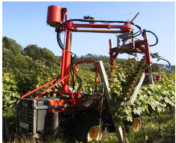
Abb. 28: Laubhefter mit Terrassenschwenkwerk der Fa. Huber Landtechnik
