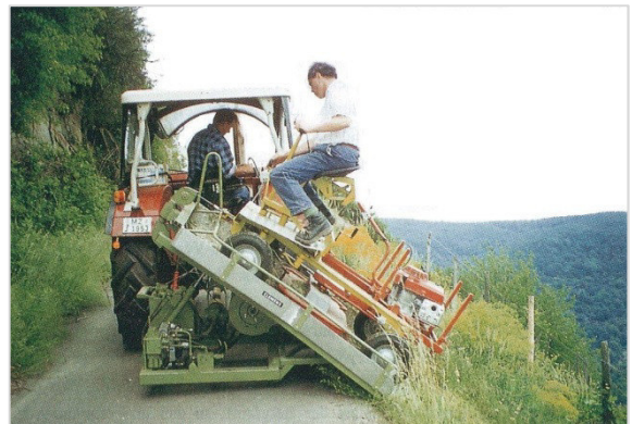
Abb. 2: Geräteträger mit Mulchgerät beim Umsetzen auf der Auffahrpritsche
